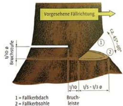
図 2.12 ドイツの伐木技術 出典：Der Forstwirt
