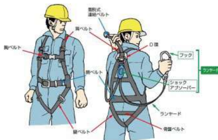
図 2.26 墜落制止用器具（フルハーネス型）
